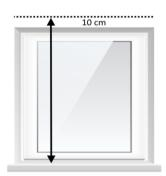
Высота изделия = высота проема + 10 см (рекомендуемая высота крепления жалюзи к стене). В случае крепления к потолку высота изделия = расстояние от потолка до нижней точки проема.
